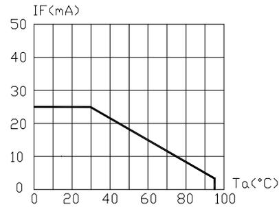
FIG.5 MAXIMUM FORWARD CURRENT VS. AMBIENT TEMPERATURE (<math>T\_{jmax}=105^{\circ}C</math>)
