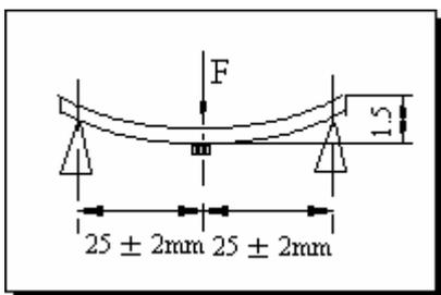
将产品按图焊在 1.6 ± 0.2mm 的 PCB 板中间, 由箭头方向施力: 1mm/S, 弯曲距离: 1.5mm, 保持 5 ± 1S, 产品金属层无脱落。
