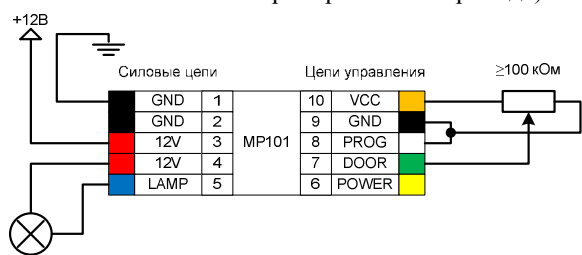
Рис.3. Подключение в режиме диммера (вид на модуль сверху, со стороны компонентов).
